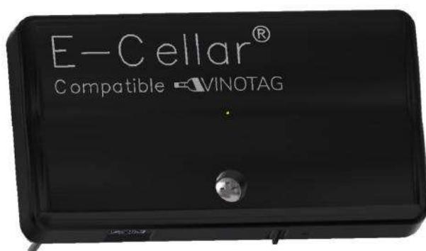
Ваш шкаф оборудован мастер-боксом. Этот блок находится внутри шкафа, вверху справа; он обеспечивает связь между полками и приложением для смартфона VINOTAG® посредством передачи данных через Wi-Fi.
