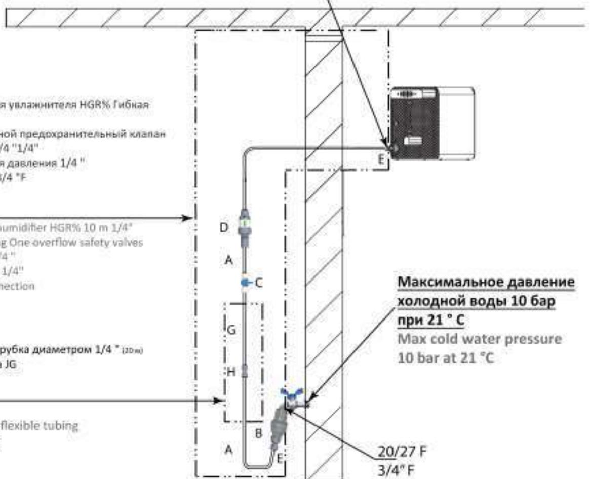
**Максимальное давление холодной воды 10 бар при 21 ° C**
